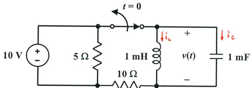
$$i_L(0) = \frac{10V}{10\Omega} = 1A, \quad v(0) = 0$$
